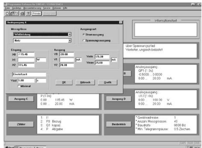
Bild 13. Programmierung der Ausgangs-Messgrößen.
