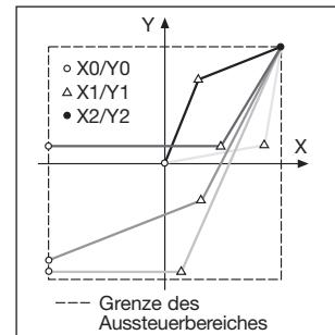
Bild 11. Beispiele für Einstellmöglichkeiten bei geknickter Kennlinie.
