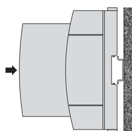
Bild 5. Montage auf Hutschiene
