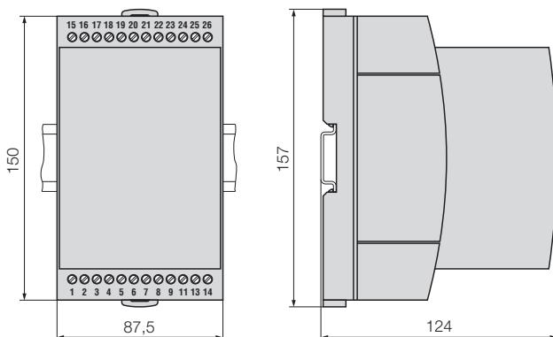
Bild 18. SINEAX DME im Gehäuse **T24** auf Hutschiene (35×15 mm oder 35×7,5 mm, nach EN 50 022) aufgeschnappt.
