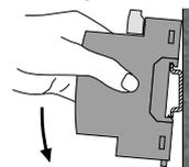
Figura 1. Fissaggio su guida 35 x 15 oppure 35 x 7,5 mm.
