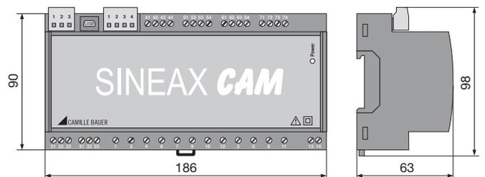
SINEAX CAM en boîtier montable sur rail DIN (35 x 15 mm ou 35 x 7,5 mm). Bornes enfichables en partie.
