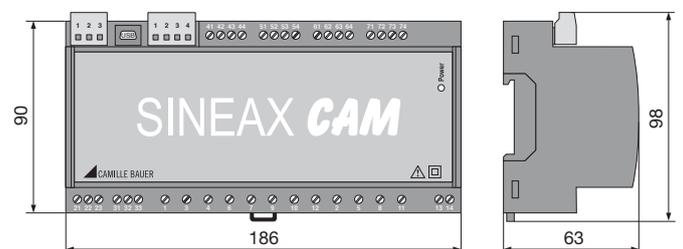
SINEAX CAM en montaje sobre raíl (35 x 15 mm o 35 x 7,5 mm). Los terminales son parcialmente enchufables.
