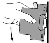
Afbeelding 1. Bevestiging op DIN-rail 35 x 15 of 35 x 7,5 mm.
