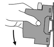
Bild 1. Befestigung auf Hutschiene 35 x 15 oder 35 x 7,5 mm.
